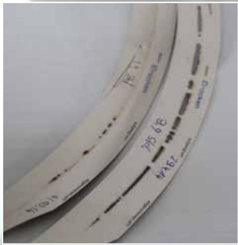
Scheint die Sonne, brennt sie durch die Glaskugel in diese Messstreifen eine Spur. Daraus kann man dann berechnen, wie lange die Sonne am Tag geschienen hat. Heute bleibt der Streifen leer.
